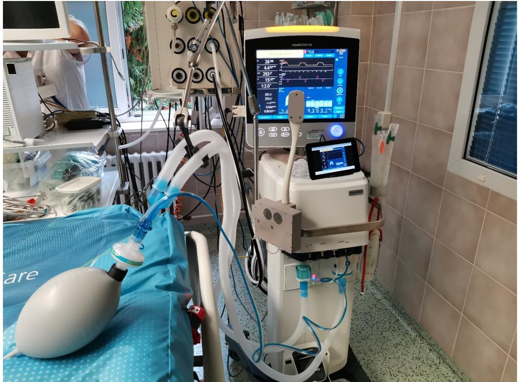
Zkouška systému VENT-CONNECT na plicním ventilátoru. Systém umožňuje vzdáleně sledovat obrazovku ventilátoru buď pomocí kamery, nebo pomocí video výstupu. Lékař si může informace zobrazit na mobilu či notebooku i mimo infekční prostředí. V současnosti je zařízení nainstalováno u 15 plicních ventilátorů a u centrálních monitorů životních funkcí na KAR FNKV. Foto: Archiv Lenky Vysloužilové, CIIRC ČVUT
